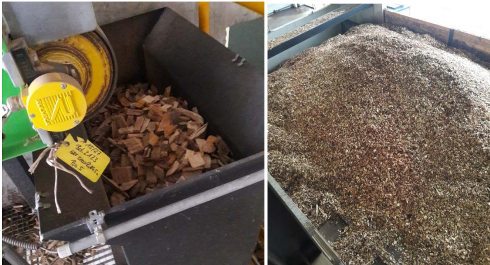
Slika 17. Izgled drvene sječke koja se koristi u daljinskom grijanju u Prijedoru
